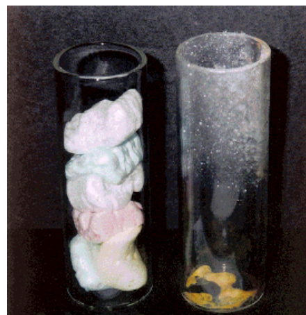
Abb. 1. Verpackungsmaterial aus Polystyrol vor (links) und nach der Reaktion (rechts) unter den Standardbedingungen (170 °C, 16 h; Partialdrücke: 275 kPa NO, 690 kPa O 2 , 3170 kPa N 2 ). Das Polymer wurde vollständig umgesetzt, das Produktgemisch hat sich z.T. als Sublimat auf der Gefäßwand niedergeschlagen.
